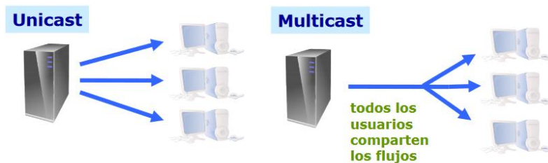
Figura 5. Tipos de transmisión de streaming. Tomado de Tecnologías de Streaming por Suárez (2010/2011).
