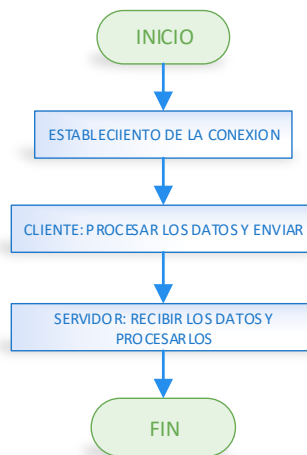
Figura 16. Diagrama de flujo de la subrutina envió/recepción de datos.
