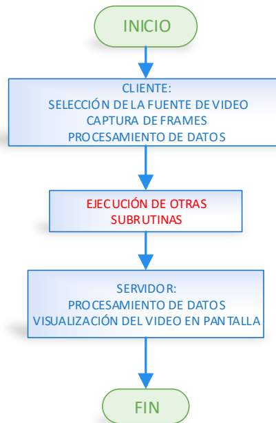
Figura 14. Diagrama de flujo de la subrutina captura/visualización del video.
