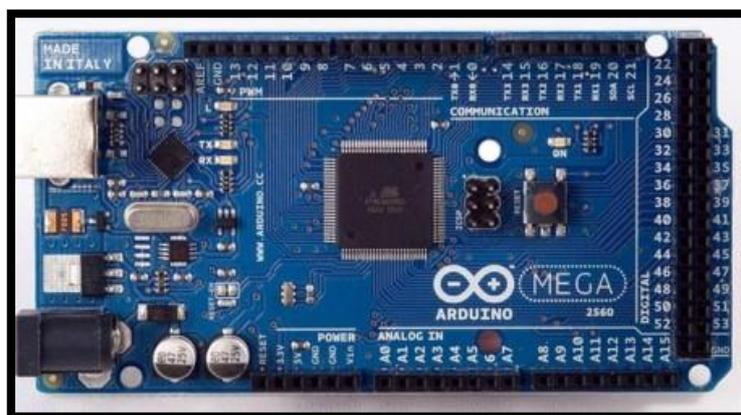
**Figura 1.1 Placa Arduino**
