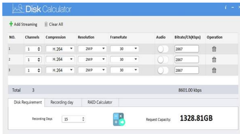
Figura 3.6 Cálculo de espacio en disco duro para grabación de imágenes y video
