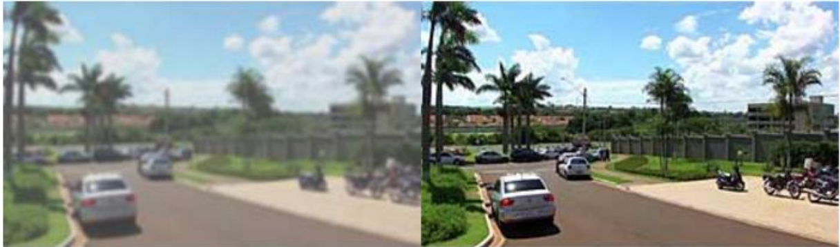
Figura 1.11 Comparativa entre a) Cámara analógica de 600TVL y b) Cámara digital IP avanzada de 3MP
