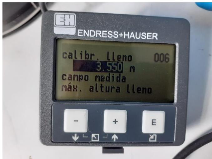
**Figura 0.36 Ajuste de sensor para nivel máximo**
