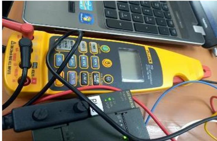
**Figura 0.32 Generador de señal analógica**
