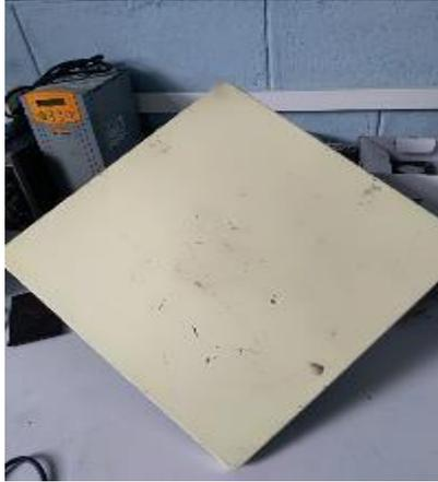
**Figura 0.13 Antena tipo panel HALO 200IA vista frontal**
