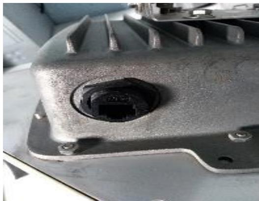
**Figura 0.15 Tipo de conectorización antena HALO 200IA**
