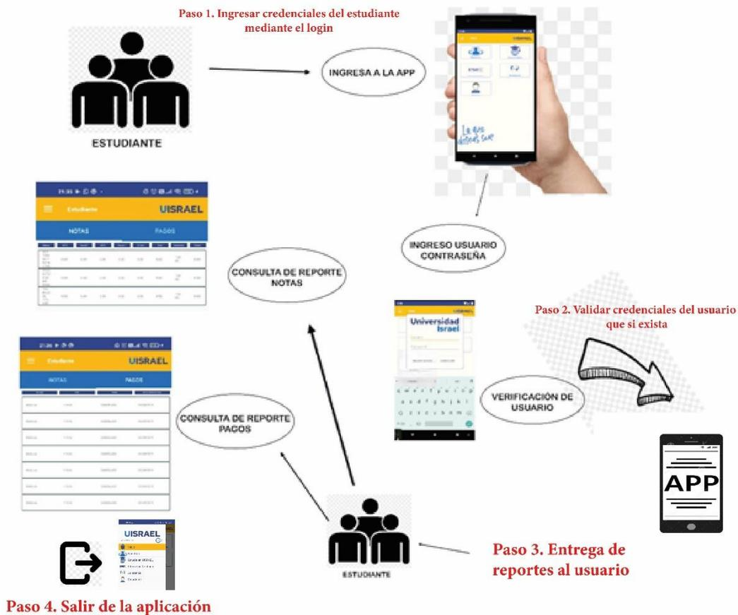
Figura 7 Esquema de Funcionamiento APP
