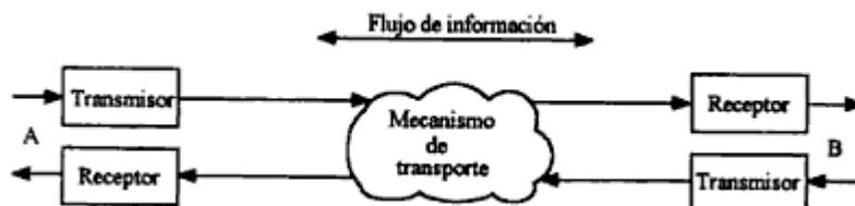
Fig.2.2 Elementos de un sistema de telecomunicaciones dúplex.<sup>3</sup>
