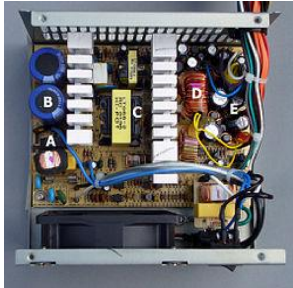
Fig. 22 Vista por dentro de una fuente conmutada ATX.
