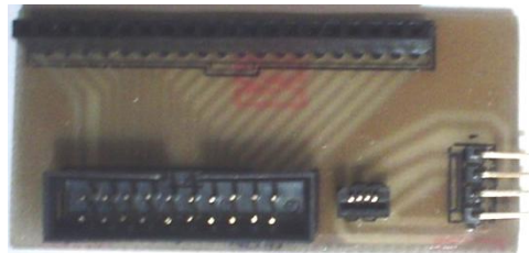
Fig. 52 Placa Interface de Comunicación Fabricada y sus Componentes
