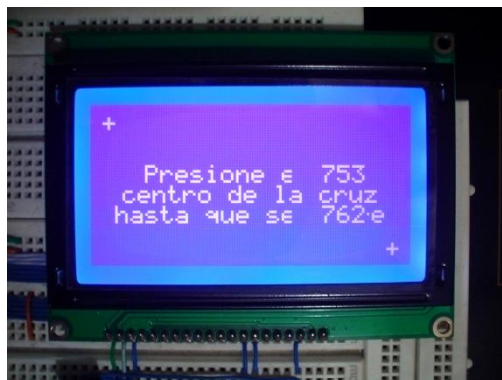
Fig. 46 GLCD pantalla de pruebas
