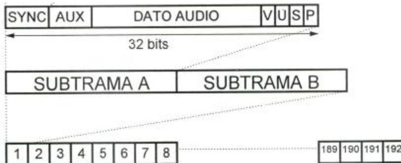
**Figura 2.17** Estructura de datos AES/EBU
