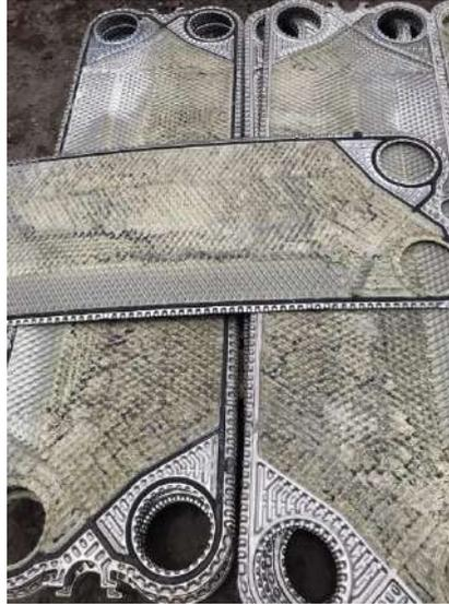
*Nota.* Se puede visualizar el grado de acumulación de incrustación por alto porcentaje de sílice en el agua de enfriamiento. Adaptada de Fotografías de registro de Interquimec S.A.
