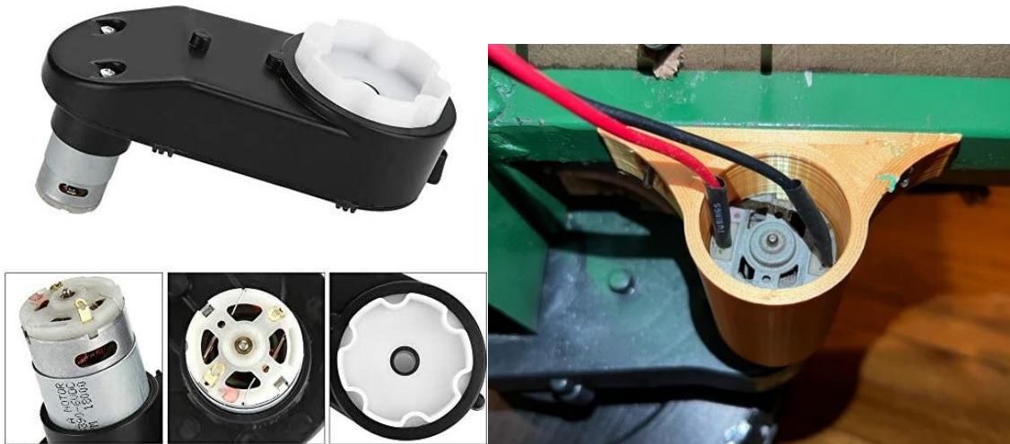
Figura 38 Instalación y conexión del motor en la llanta de atrás
