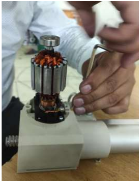
Motor de corriente continua con tornillo sin fin
