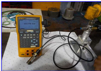
Resultados de la prueba del transmisor de presión MBS 3000
