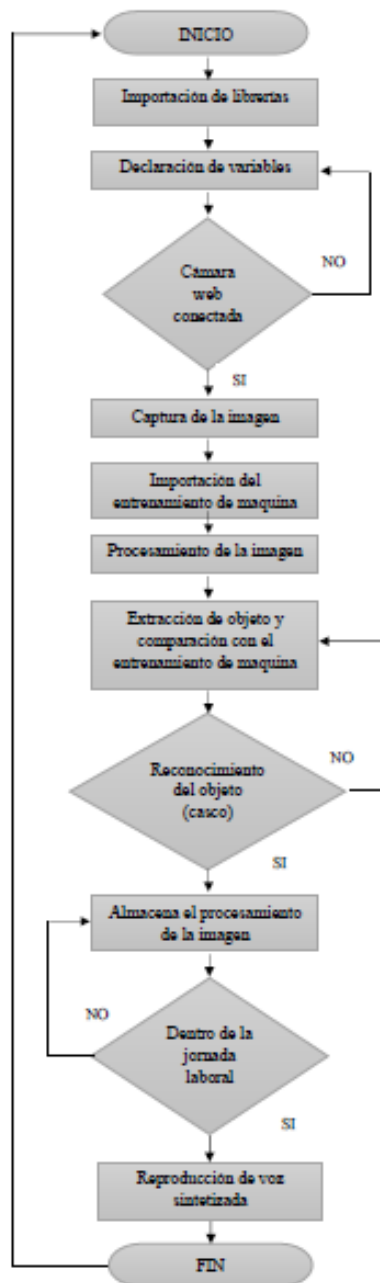
Figura 5. Diagrama de los procesos realizados por el algoritmo
