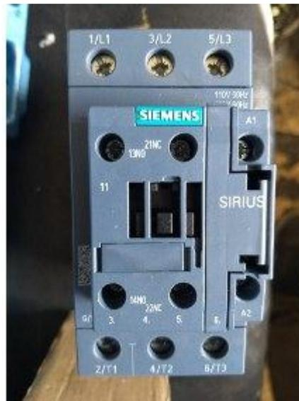
Figura 1. 11. Contactor electromagnético
