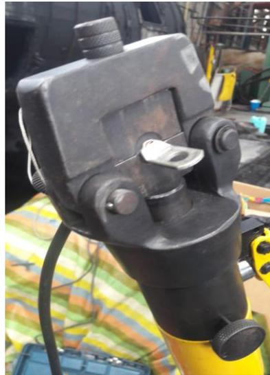
Figura 4. 17. Conexión de los cables con sus respectivos terminales
