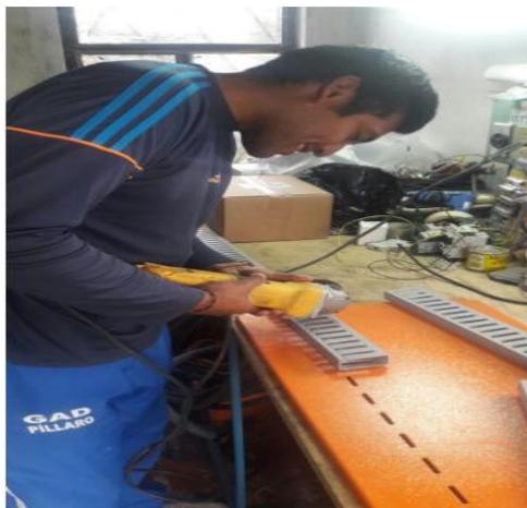
Figura 4. 3. Dimensionamiento de canaletas
