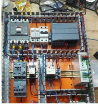
Figura 4. 6. Conexión de los elementos de potencia y control
