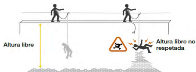
Figura 23. Ca3da por altura libre no respetada
