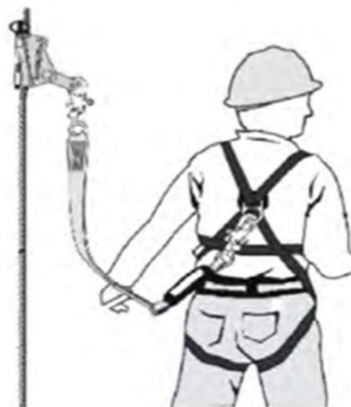
Figura 30. Utilización de líneas de vida
