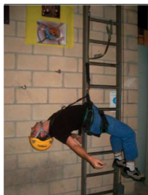
Figura 27. Efecto de la fuerza de choque por caída
