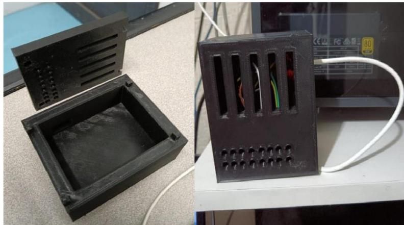
**Nota:** El prototipo posee una distancia de separación entre la tapa y la base a fin de abarcar la mayor cantidad de aire presente en el ambiente en conjunto con las perforaciones presentes en la tapa.
