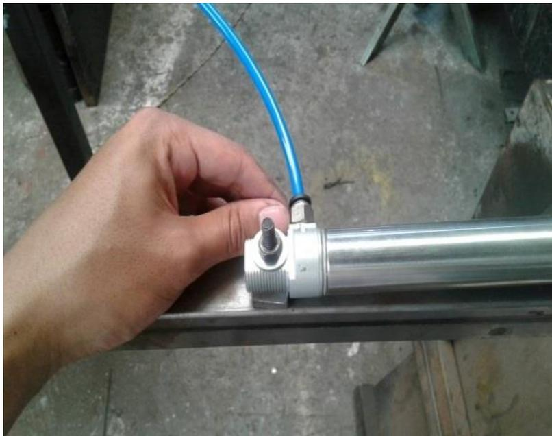
Se procede a llevar a cabo el mantenimiento preventivo del distribuidor de aire, verificando la ausencia de fugas de aire y asegurándose de que todas las mangueras estén correctamente conectadas. Este mantenimiento se realiza una vez por semana para garantizar el funcionamiento óptimo del distribuidor y prevenir posibles problemas en el sistema neumático.
