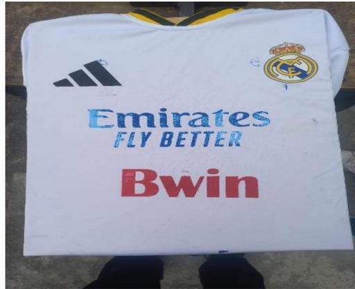
Una vez estampado los 3 primeros colores retiramos la camiseta y la colocamos en una plancha de secado rápido y así tenemos la impresión de los primer colores en la parte frontal de la camiseta
