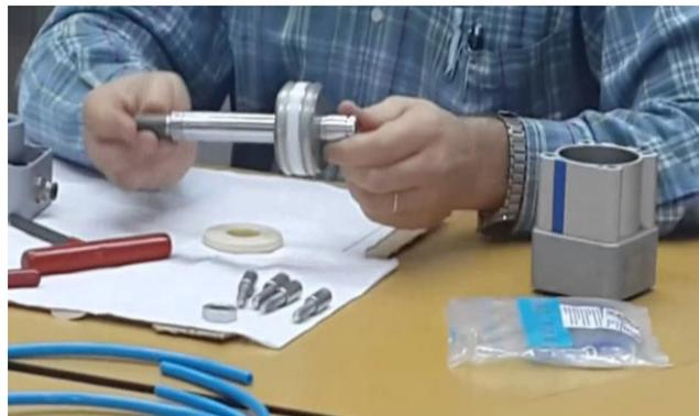
Además, es importante realizar mantenimientos preventivos en el cilindro neumático de vástago cuadrado cada 15 días. Durante este proceso, se deben revisar las posibles fugas de aire y asegurarse de que todas las mangueras estén correctamente conectadas. Esto garantizará un funcionamiento óptimo y evitará posibles problemas en el sistema neumático
