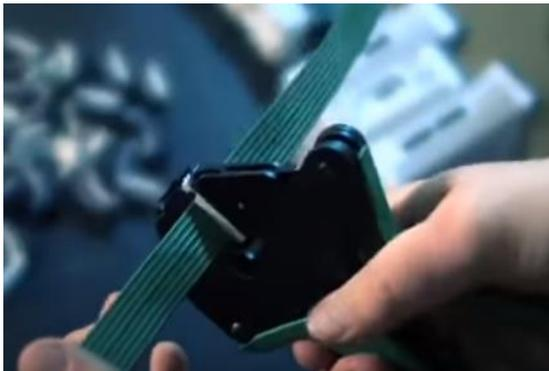
La Figura 3. indica la forma adecuada de ponchado de cada uno de los dispositivos de comunicación dentro de la red Smart wire.
