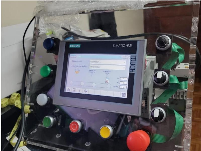
La Figura 14. muestra al sistema energizado, enviando datos de los dispositivos electrónicos inteligentes para su respectiva presentación en el HMI Local
