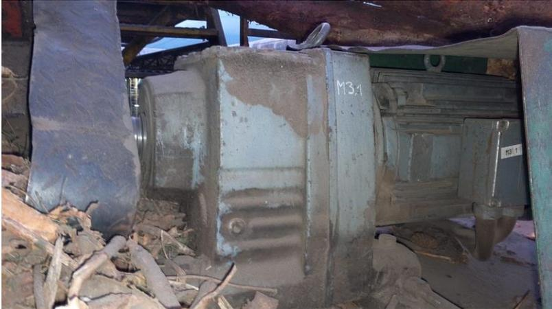
Los troncos se introducen dentro del tambor descortezador para que al girar desprenda la corteza del tronco, para lo cual consta de dos motores ABB como muestra en la figura 5 que es el motor del lado oriente.
