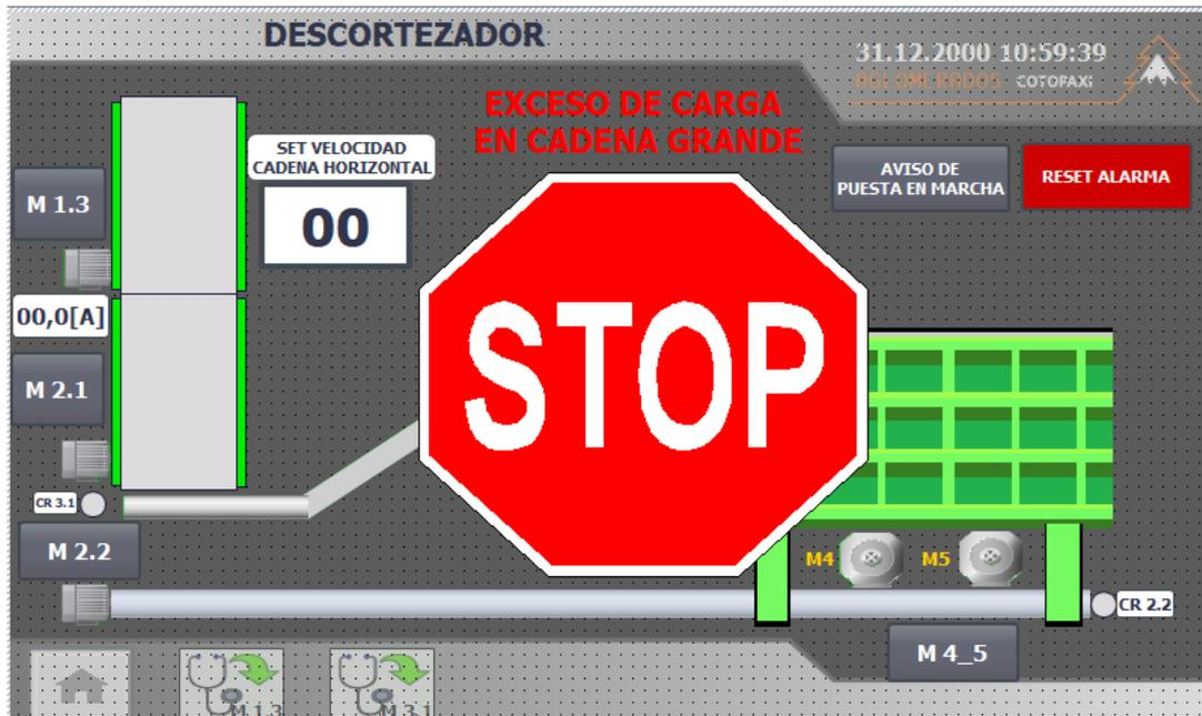
De igual manera si tiene problemas con el CR de la banda de corteza se podrá visualizar en la pantalla HMI, si está trabajando de manera correcta será de color verde, caso contrario será de color rojo y tendrá un parpadeo, como muestra la figura siguiente.
