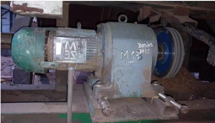
Continuando con el proceso, después de que el tronco recorra la cadena horizontal de alimentación pasa por una cadena inclinada que es la que inyecta los troncos hacia la cadena grande. El motor que se tiene en ese lugar se lo muestra en la figura 3.
