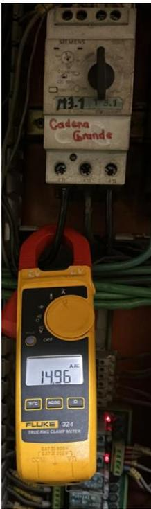
Una vez se tenga el valor de corriente medido con el multímetro se procede a escalar en el programa TIA PORTAL, se utiliza como ejemplo en el documento la medida tomada que es de 14.96A y se procede a escalar los límites por lo que para obtener el resultado exacto es 0 a 58, como muestra la figura 66.
