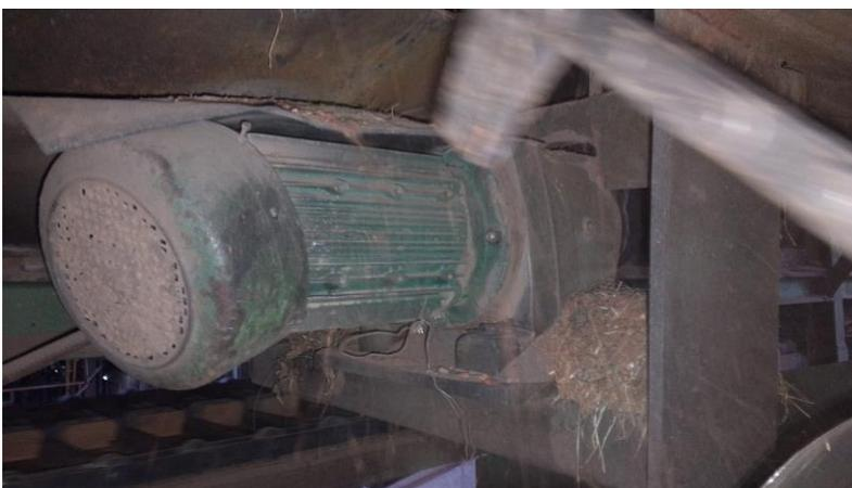
Una vez hayan pasado los troncos por las cadenas de alimentación llega al motor denominado como cadena grande, representada en la figura 4, ésta se encarga de transportar los troncos hacia el tambor descortezador.
