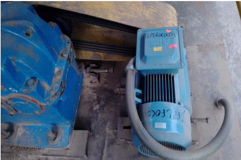
De igual manera, en la figura 6 se muestra el motor del lado occidente del tambor descortezador.
