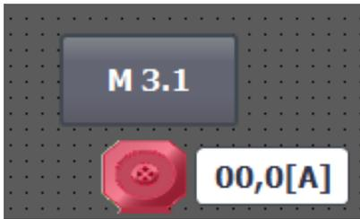
Al colocar un TC dentro del diagrama de conexión para poder observar el comportamiento de corriente que tiene este motor con respecto a la carga que se introduce en él, se ha configurado la entrada analógica en TIA PORTAL, de esta primero se revisa el valor de consumo de corriente con un multímetro como muestra la figura 65.
