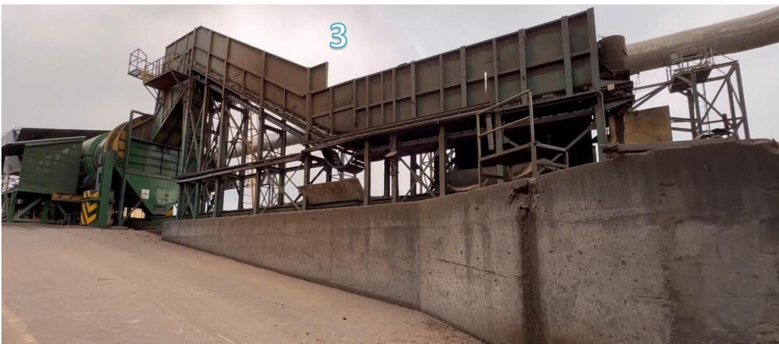
Mediante la cadena grande llegan los troncos hacia el tambor descortezador el cuál es el encargado de sacar toda la corteza del tronco. Los motores para la interpretación se los muestra como 4 y 5 respectivamente en la figura 31.
