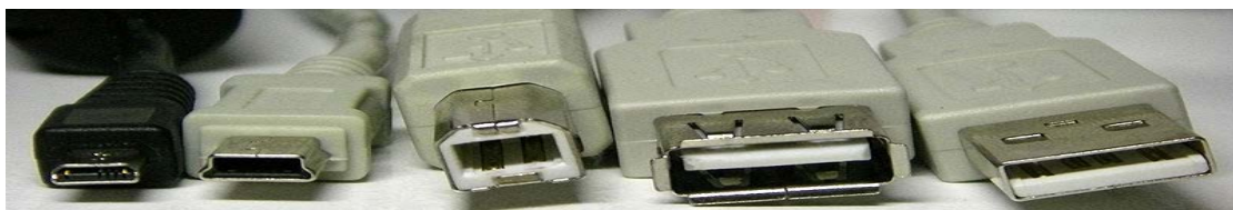
Figura 2.8. Tipos diferentes de conectores USB (de izquierda a derecha): micro USB macho, mini USB, tipo B macho, tipo A hembra, tipo A macho
