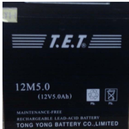
Figura 3.15. Batería utilizada para módulo lector
