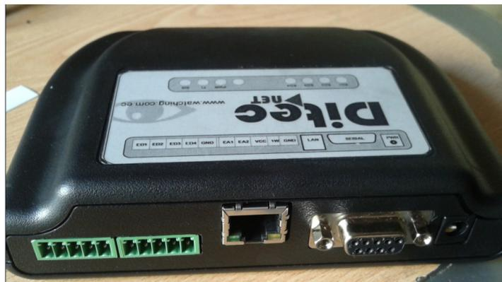
**Ilustración 23** Dispositivo de telemetría DITEC NET
