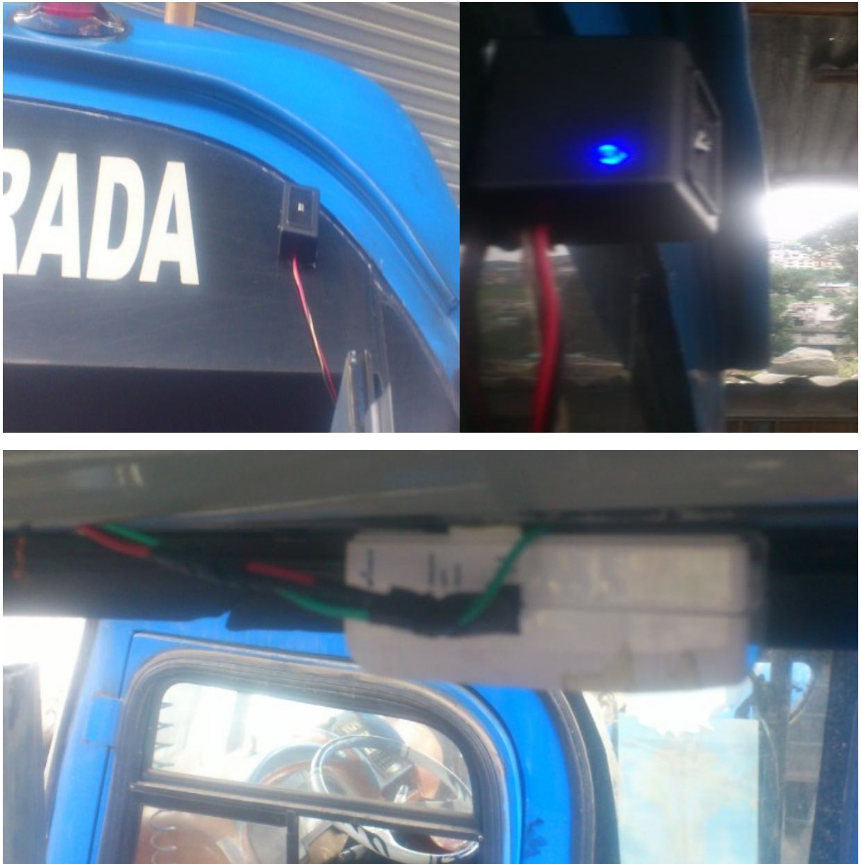
Figura 4. 6 Implementación de Sensores en el Bus
