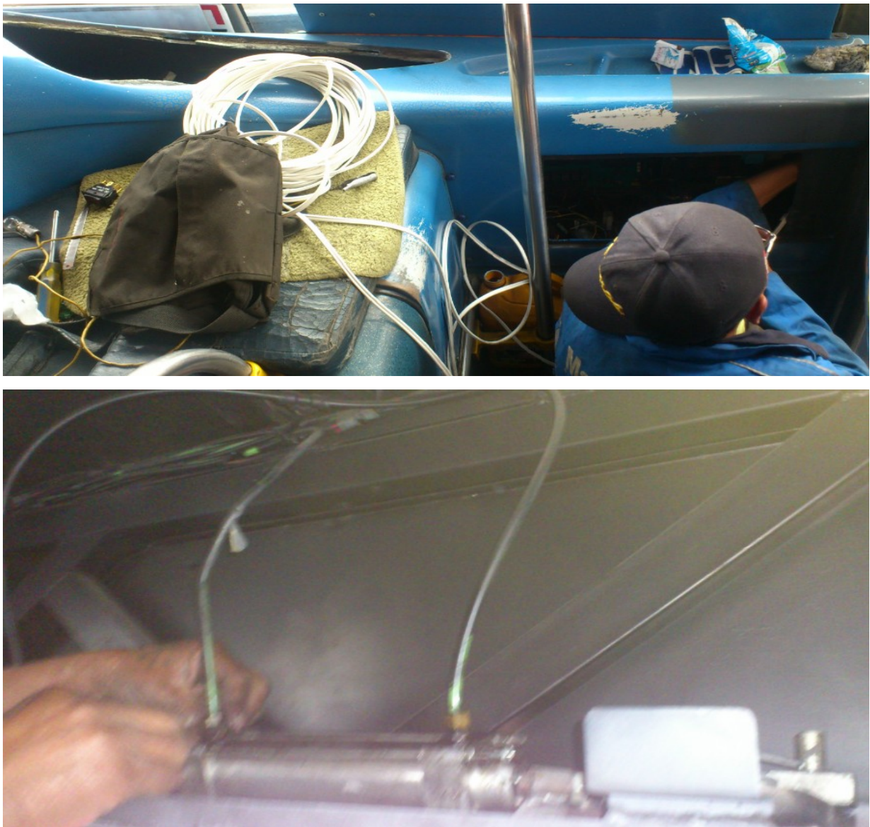
Figura 4. 4 Verificación de Cilindros y Caja de Fusibles para Acople de Electroválvulas
