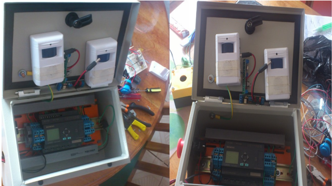
Figura 4. 3 Verificación de Funcionamiento Sensores
