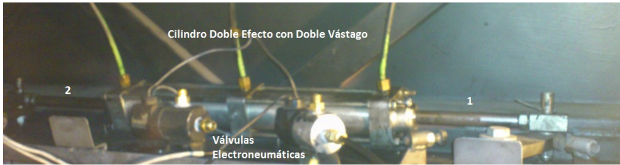
Figura 3. 13 Válvulas Electroneumáticas para Cilindro Doble Efecto 15
