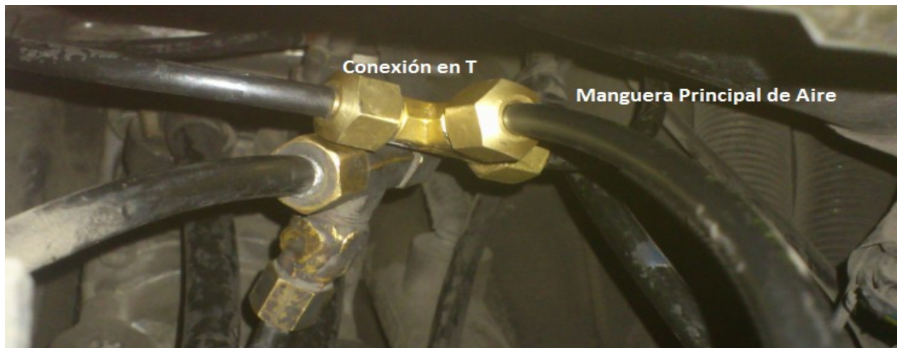
Figura 3. 12 Conexión en T para Alimentación de Válvulas Electroneumáticas 15
