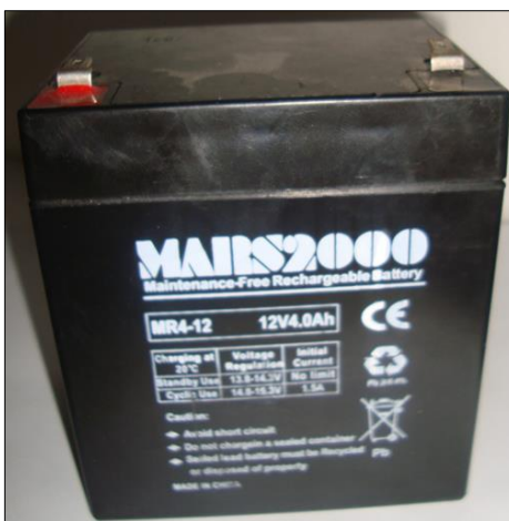
Figura 2.14 Batería de 12 Vdc
