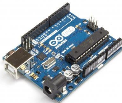
Figura 1.5 Microcontrolador Arduino UNO Fuente: (Torrente, 2010)
