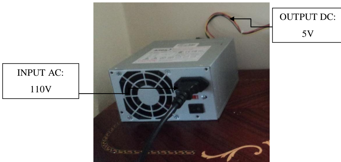
Figura 3.5. Fuente de Alimentación ATX con salida de voltaje 5VDC Fuente: Autor
