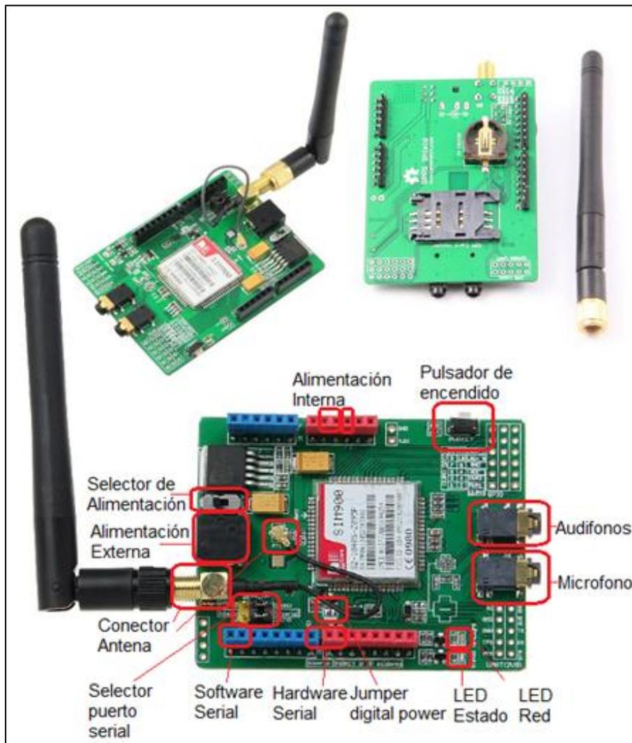
Figura 18. SIMCOM SIM900 GSM. Vista frontal, posterior e identificación de partes.
