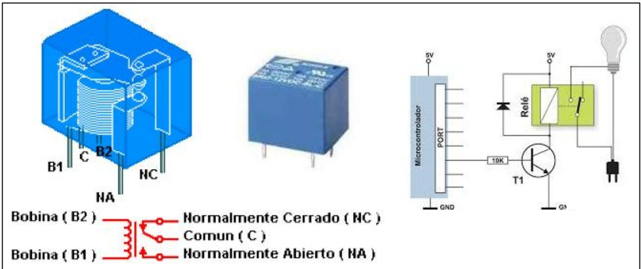
Figura 13. Composición de un Relé y circuito de disparo.
