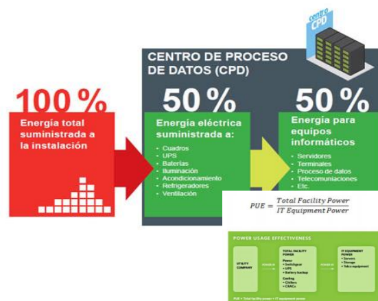
Ilustración 3.17: Partes a considerar para verificar consumo en un Data Center Fuente: Elaborado por el Autor
