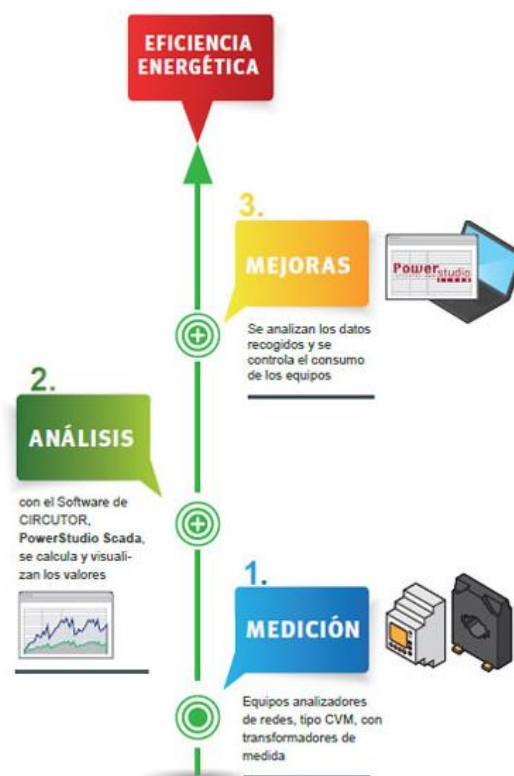
Ilustración 3.16: Pasos a considerar para implementar tecnología Smart Grid en un Data Center Fuente: Elaborado por el Autor
