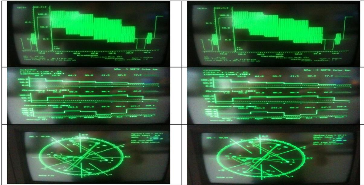
Tabla 8: Fotografías secuencial de medición de Frecuencia y Ancho de Banda de una señal de televisión estándar.
