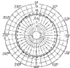
Horizontal Radiation Pattern DB408(—) and DB408L(---)
