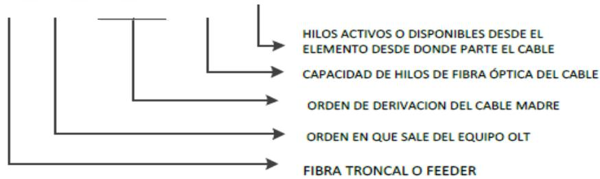
Figura 3. 18: Identificación de cables de empalme feeder
