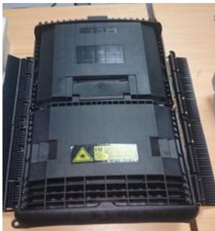
**Figura 1.13: Caja de distribución óptica NAP**
