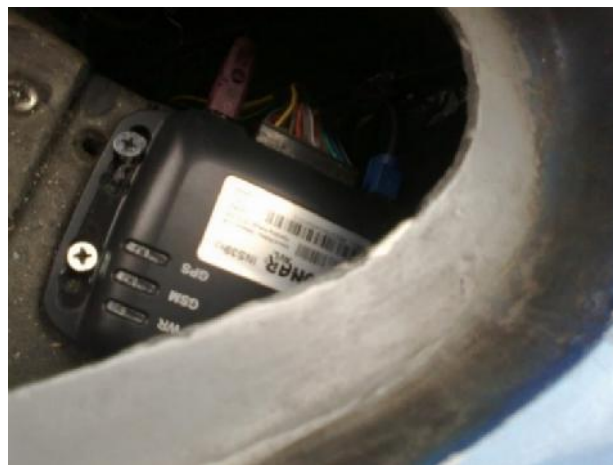
ILUSTRACIÓN 12. DISPOSITIVO INS39 INSTALADO EN VEHÍCULO FUENTE: (TRANSLATINOS & AUTOR, 2013)
