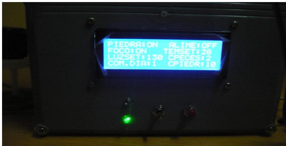
Figura 97: Foto del módulo de control principal mostrando el estado del oxigenador
