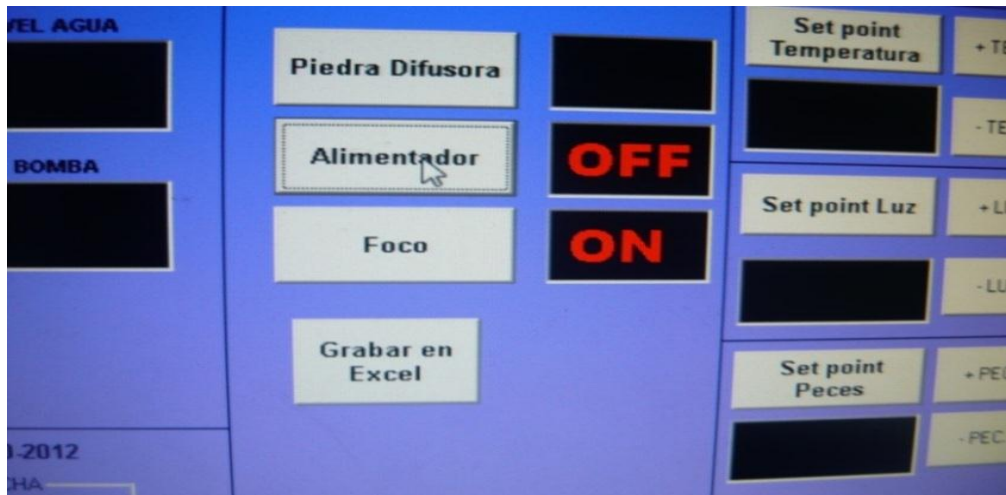
Figura 94: Foto del monitor indicando estado OFF del alimentador
