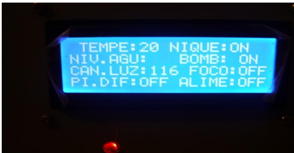
Figura 89: Foto del estado ON de la bomba de agua
