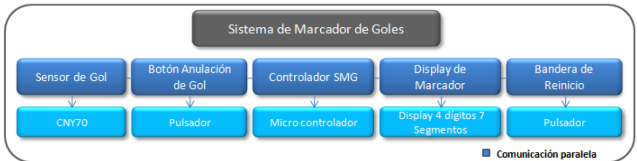
Diagrama 42 Diagrama de Componentes de hardware de Marcador de Fútbol comunicación únicamente paralelo
