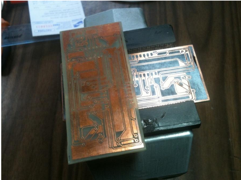
Diagrama 66 PCB de Sistema de Marcador de Gol en Baquelita de Fibra de Vidrio
