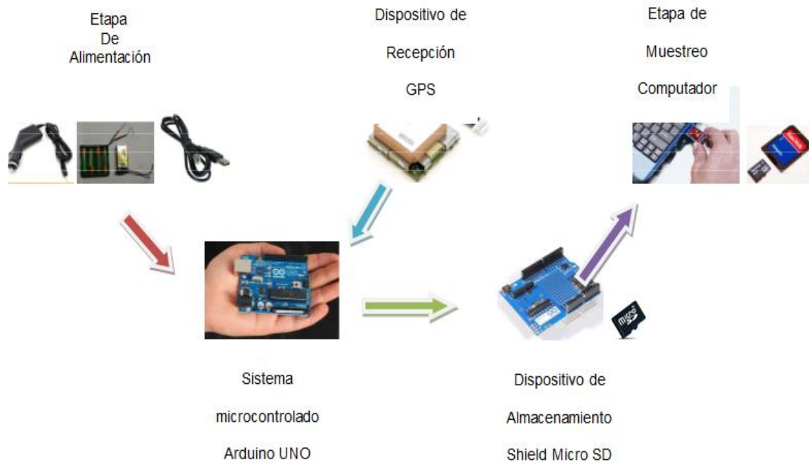
Fig. 3.5 Diagrama de etapas con elementos utilizados en sistema GPS LOCARD
