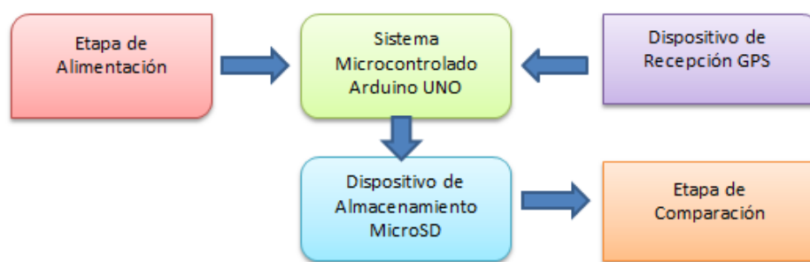
Fig. 3.4 Diagrama de Bloques Sistema GPS LOCARD
