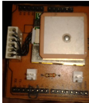
Fig. 3.14 Modulo GPS modelo EM-406A
