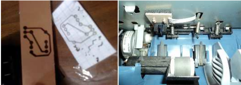
Figura 3.26 Placa electrónica para la integración de optoacopladores. Elaborado por Fernando Guevara
