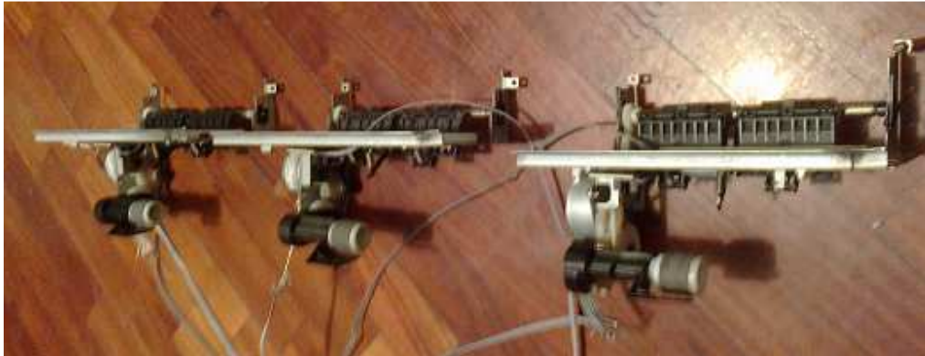
Figura 3.18 Estructuras de impresoras reducidas para acoplarse al tamaño de las papeletas. Elaborado por Fernando Guevara
