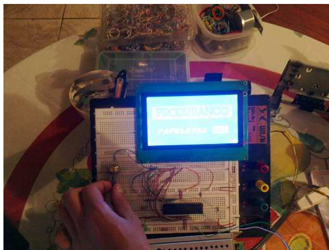
Figura 3.24 Pruebas de funcionamiento de las imágenes en el GLCD Elaborado por Fernando Guevara
