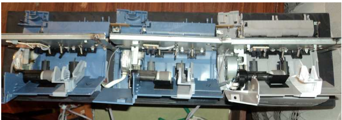
Figura 3.20 Estructura compacta con tres canales para la expulsión de papeletas. Elaborado por Fernando Guevara
