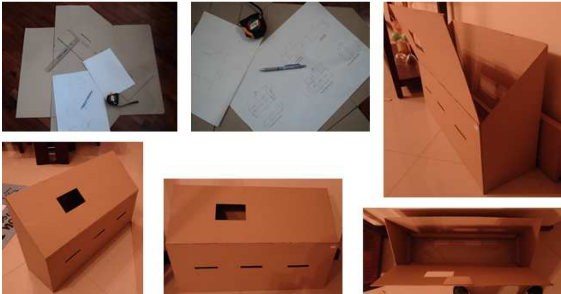
Figura 3.22 Construcción de la maqueta de la estructura externa del dispensador Elaborado por Fernando Guevara
