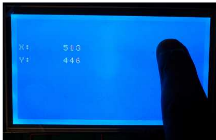
Figura 3.11 Placa Táctil presionada en el punto (513;446) Elaborado por Fernando Guevara
