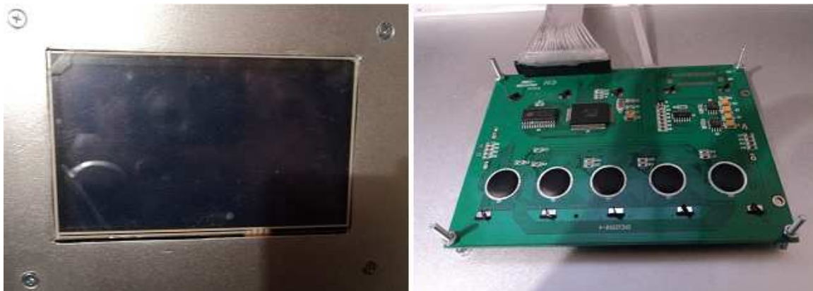
Figura 3.35 Pantalla de cristal líquido y placa táctil, ensambladas en la estructura del dispensador Elaborado por Fernando Guevara
