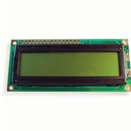
**Figura 2.7.** Pantalla LCD 16x2
