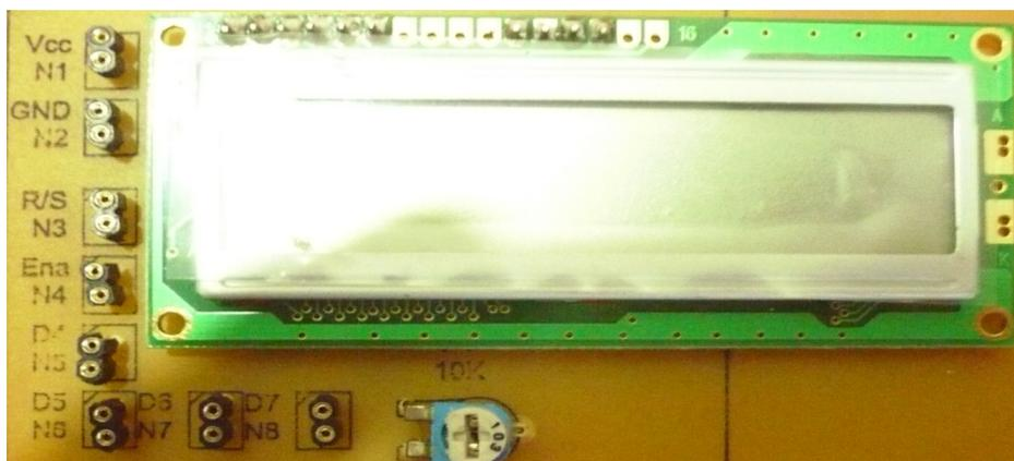
**Figura 3.34.** Conexión de los pines de la etapa de la pantalla LCD
