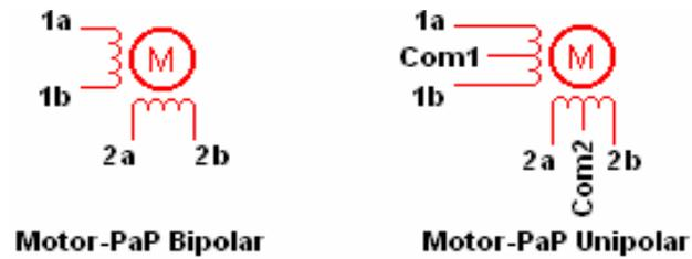
**Figura 2.8.** Motores PAP Bipolar y Unipolar
