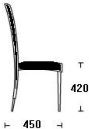
Figura 3.1.1.4 Silla De Trabajo (cotas en mm)
