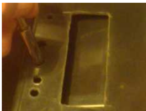
Figura 3.26 Apertura los orificios para los leds y botón de control
