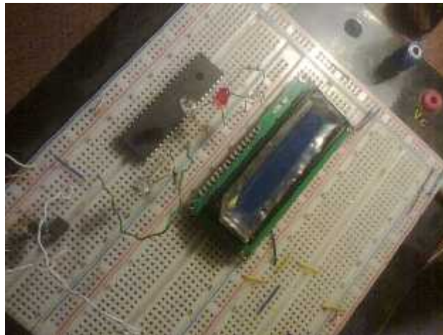
Figura 3.16 Fotografía etapa de análisis y comunicación ATmega-LCD
