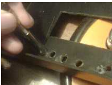
Figura 3.27 Ampliación de los orificios para el ajuste de la placa a la caja
