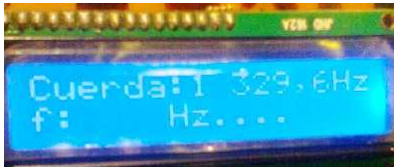
Figura 3.18 Visualizador funcionando después de las etapas de regulación, conversión análogo-digital y análisis.
