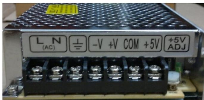
**Figura 3.6:** Aspecto físico de la fuente conmutada.
