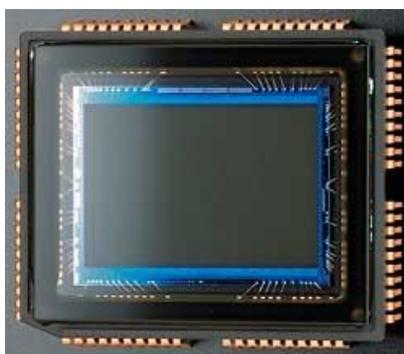
**Figura 2.9:** Sensor CCD.<sup>18</sup>
