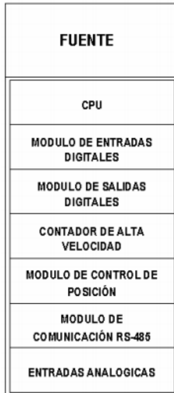
Figura 5 - Estructura General de PLC 4
