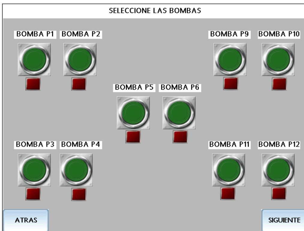
Figura 40.- Pantalla de Mando de las Bombas
