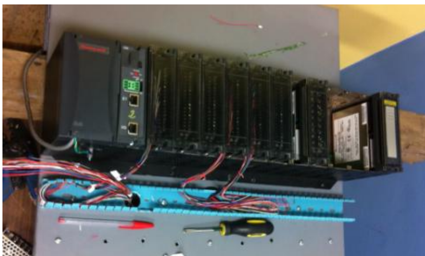
Figura 45.- Conexión de los módulos
