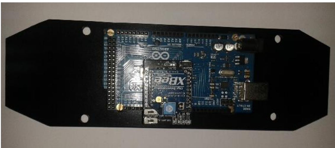
Fig.3.29 Montaje de placa Arduino Mega 2560 en pieza superior.
