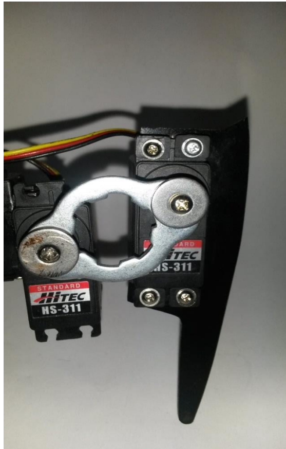
Fig.3.34 Montaje de Extremidad individual.
