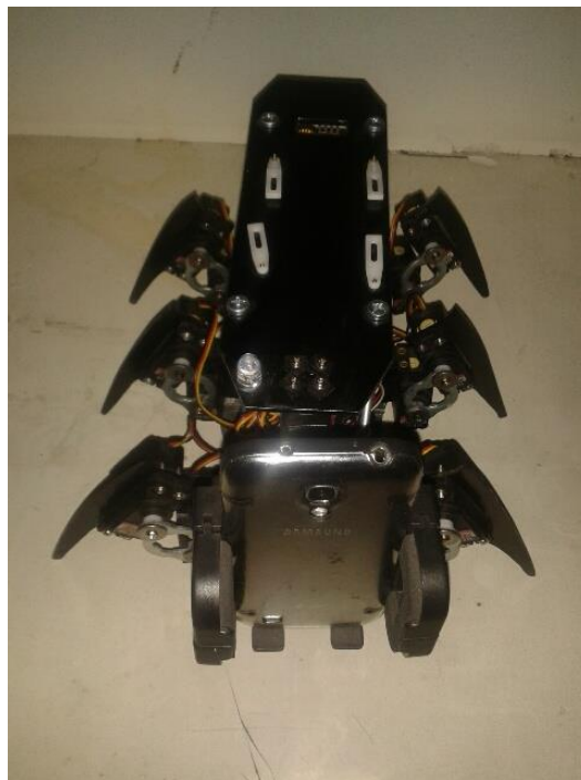
Fig.3.41 Implementación de soporte para dispositivo android.
