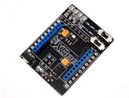
Fig.3.17 Xbee Shield para Arduino Mega 2560
