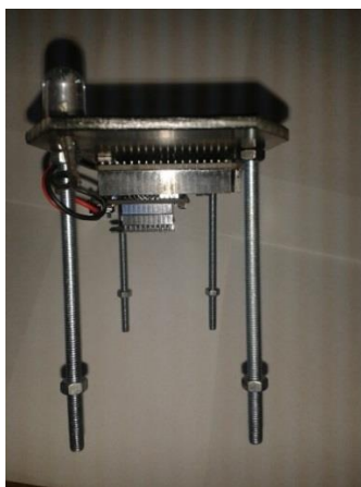
Fig.3.31 Ensamble Base superior con placa Arduino/tornillos/Led indicador
