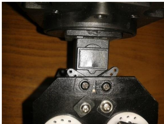
Fig.3.39 Acople del servomotor de dirección de cámara a la base.
