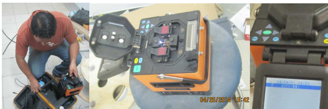
Figura 3.27 Preparación y calibración de la fusionadora 44
