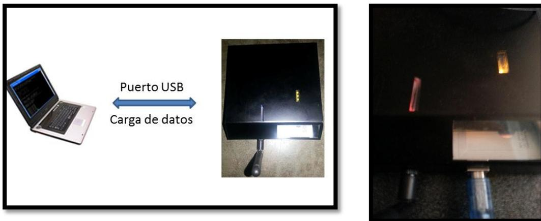
**Figura 4.1** conexión por puerto USB para el grabado de números de teléfono en las tag
