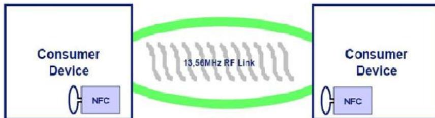
**Figura 2.2 Ilustración de comunicación NFC**
