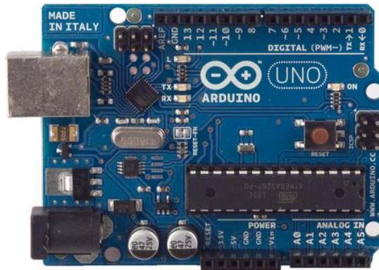
**Figura 2.8 Placa Arduino UNO**
