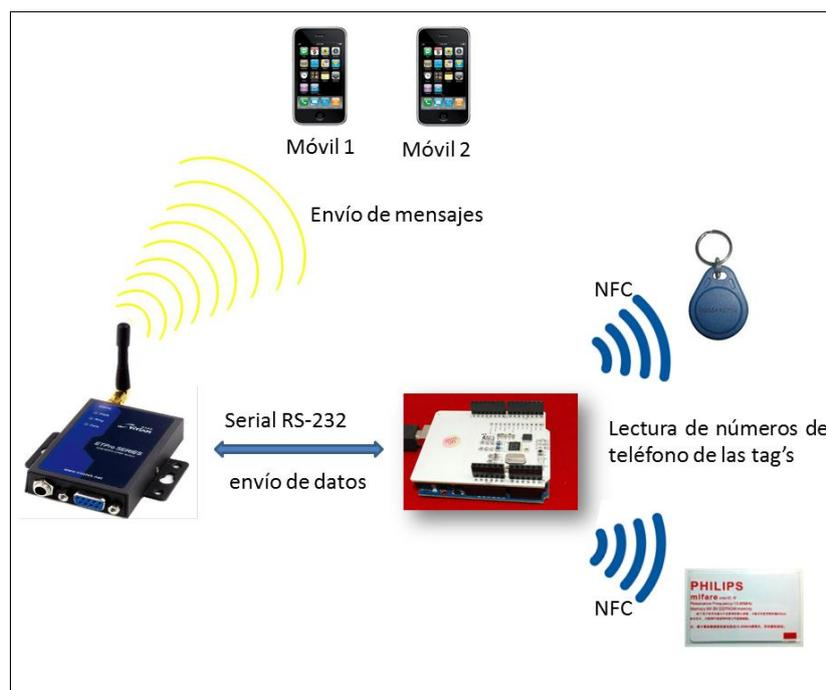
**Figura 3.7 Elementos del dispositivo de seguridad NFC**
