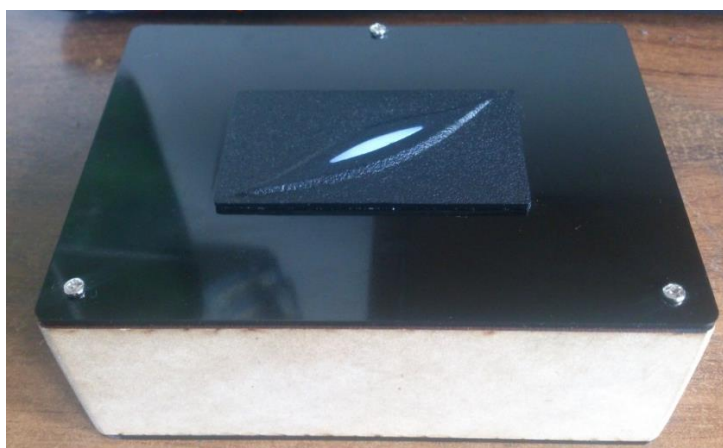
Fig. 3.28 DIV armado con tapa, base y paredes incluyendo la placa electrónica.
