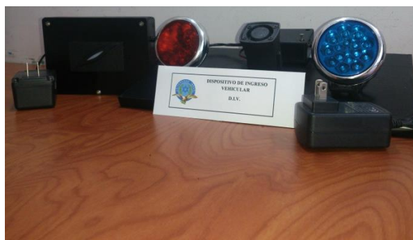
Fig. 3.39 DIV terminado con respectivas alertas visuales y audibles.
