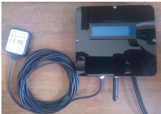
Fig. 3.25 DVV armado con tapa, base y paredes incluyendo la placa electrónica.
