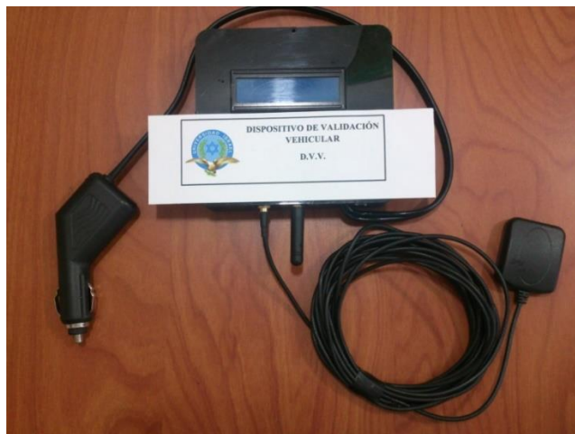
Fig. 3.43 DVV terminado con sus antenas para sus respectivas comunicaciones.
