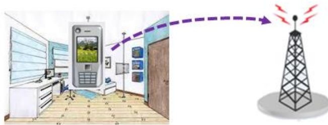
Figura 3: Pérdida por penetración
