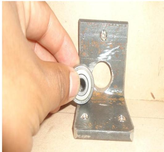
**Figura 29.** Soporte del vástago del tornillo sin fin, por Edwin Peralta
