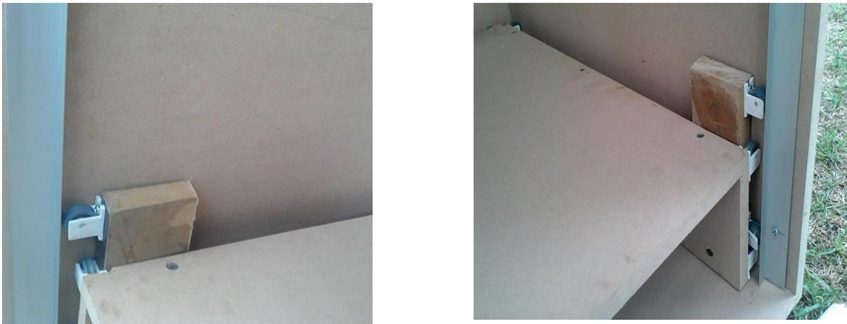
***Figura 27. Ruedas colocadas en los extremos del sistema de empuje, por Edwin Peralta.***
