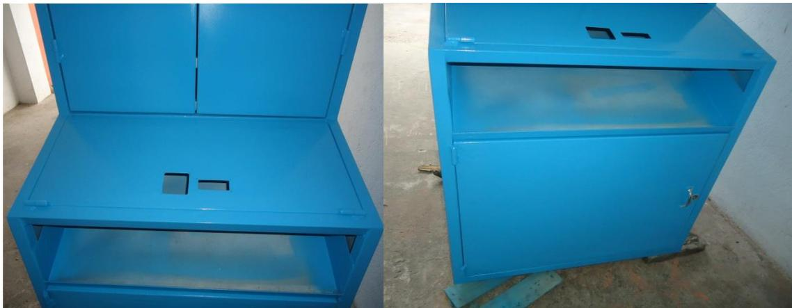
**Figura 58.** Armazón metálico del dispensador de resmas, por Edwin Peralta
