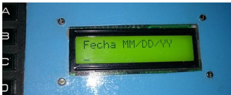
**Figura 72.** Pantalla de petición de dato MM/DD/YY, por Edwin Peralta.
