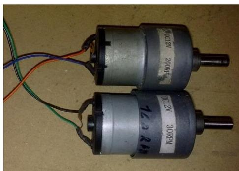
**Figura 37.** Motor de 30RPM y 200RPM físicamente iguales, por Edwin Peralta
