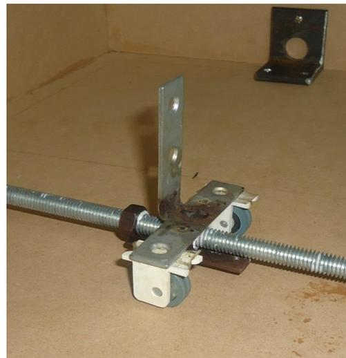
**Figura 31.** *Carrete de Empuje que se Desplaza por el tornillo Sin Fin, por Edwin Peralta*
