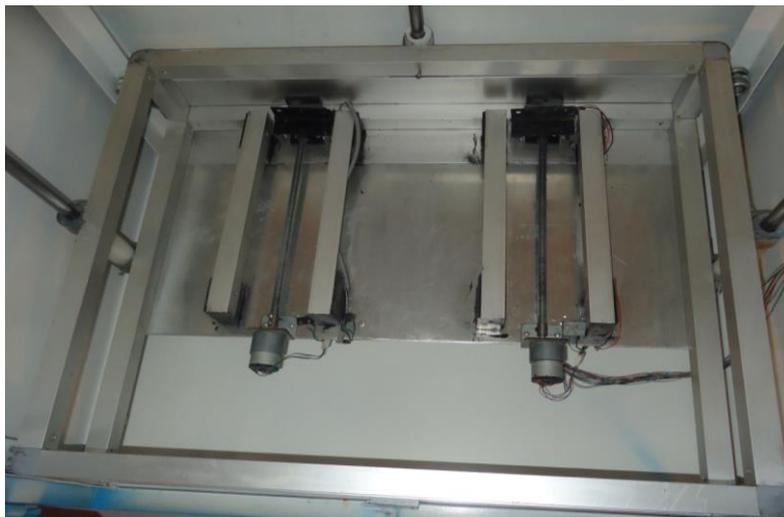
**Figura 40.** Sistema de empuje en aluminio, por Edwin Peralta.
