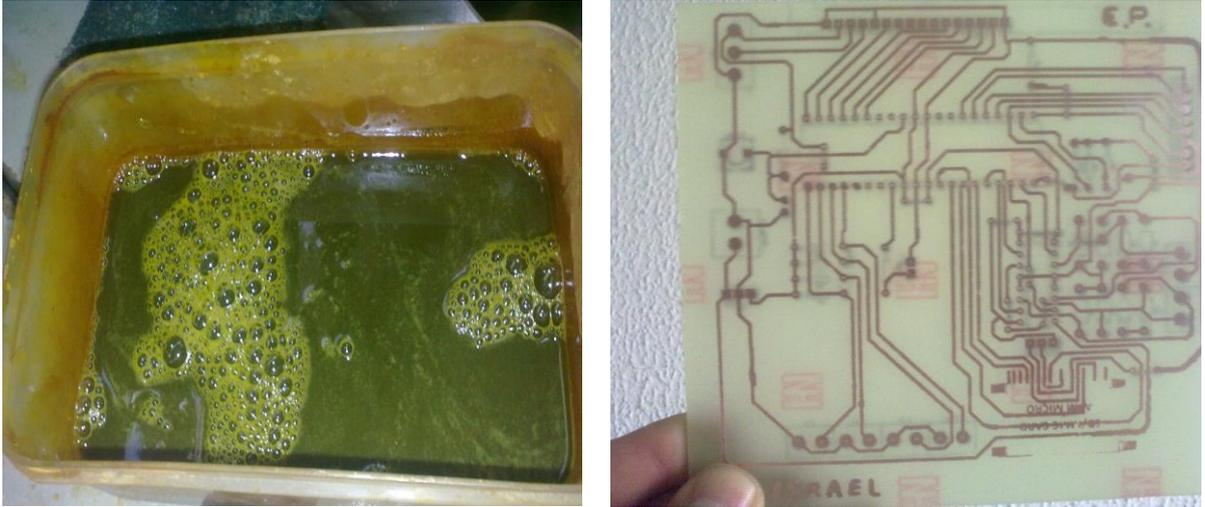
**Figura 52.** *Ácido clorhídrico para retirar cobre, por Edwin Peralta.*
