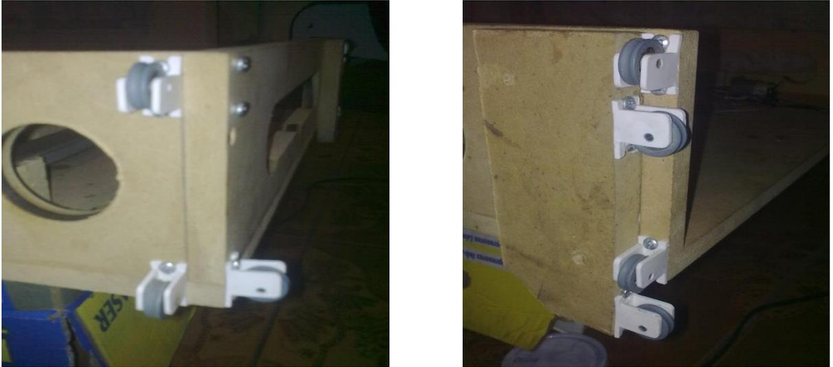
**Figura 28.** Ruedas de plástico para encaminar el sistema de empuje, por Edwin Peralta
