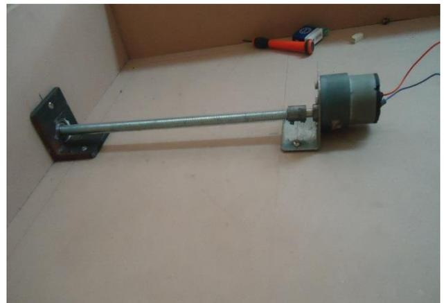
**Figura 32.** Acople del Tornillo sin fin y motor DC, por Edwin Peralta.
