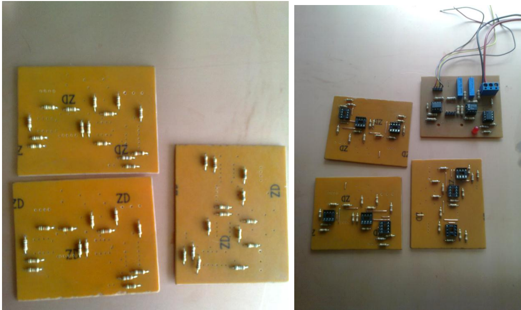
Figura 3.13. Proceso de colocación de los elementos en las 5 diferentes placas
