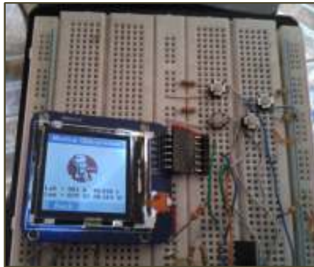
Figura 3.36. Funcionamiento del LCD mostrando foto (Fuente: José Luis Díaz)
