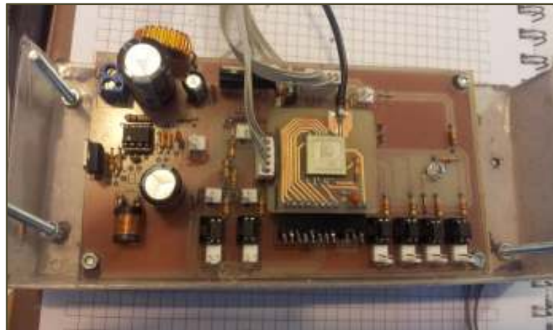
Figura 3.32. Montaje de la placa en la cubierta del prototipo.
