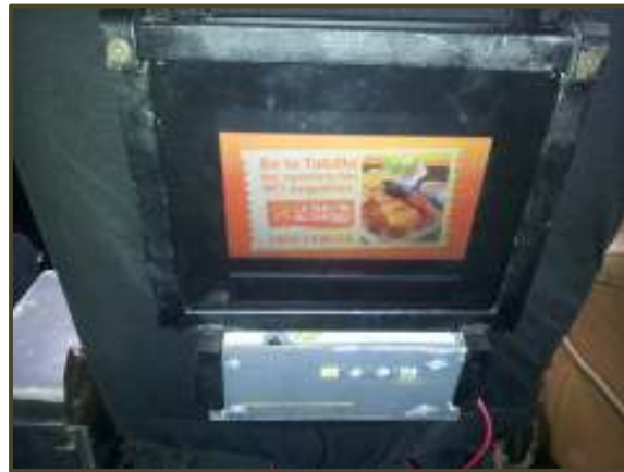
Figura 3.43. Reproducción de publicidad de La Tablita en prototipo al detectar posición correspondiente.
