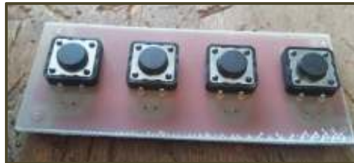
Figura 3.29. Fijación de los pulsadores en la placa PCB (Fuente: José Luis Díaz)
