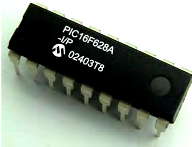
Figura 3.3.1.1. Fotografía de un micro-controlador PIC16F628A. Fuente: (Reyes, 2008, p. 22).
