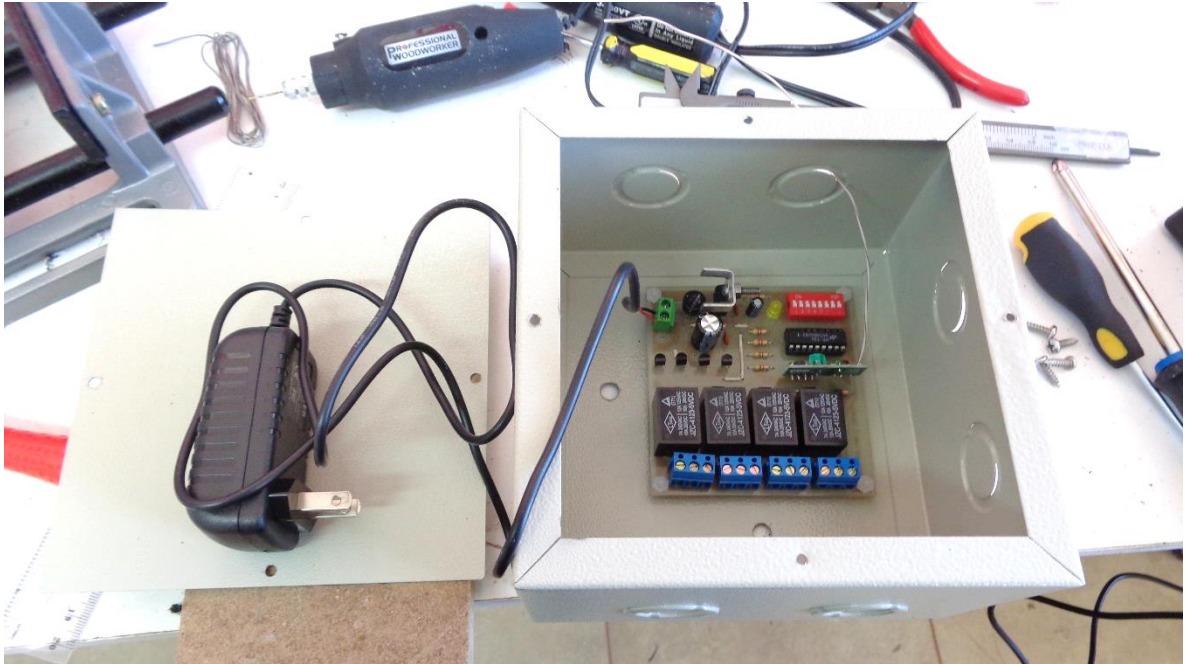
Figura 3.8.8. Preparando la tarjeta de control II para la implementación.
