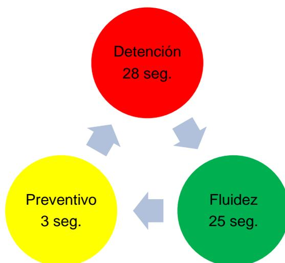
**Figura 3.3.** Ciclo del Funcionamiento de un semáforo electromecánico
