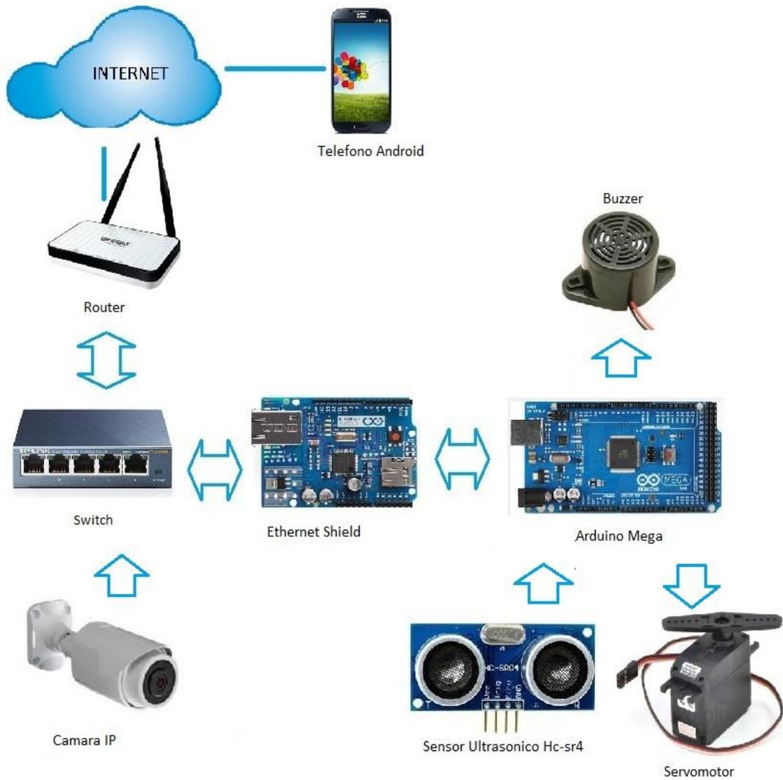
**Figura 31.** Esquema básico de conexiones
